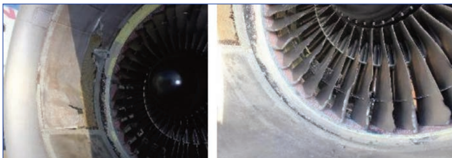
Daños en el motor izquierdo
